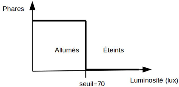
Le basculement de « phares allumés » vers « phares éteints » se faisant sur un seul seuil, que se passe-t-il lorsque la luminosité est juste de 70 lux ?
